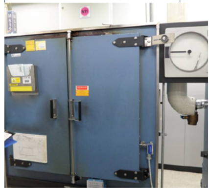
몰드 후 경화(post mold cure oven)
